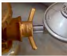
T.v. Gasolbehållare med monterad reducerventil 2
